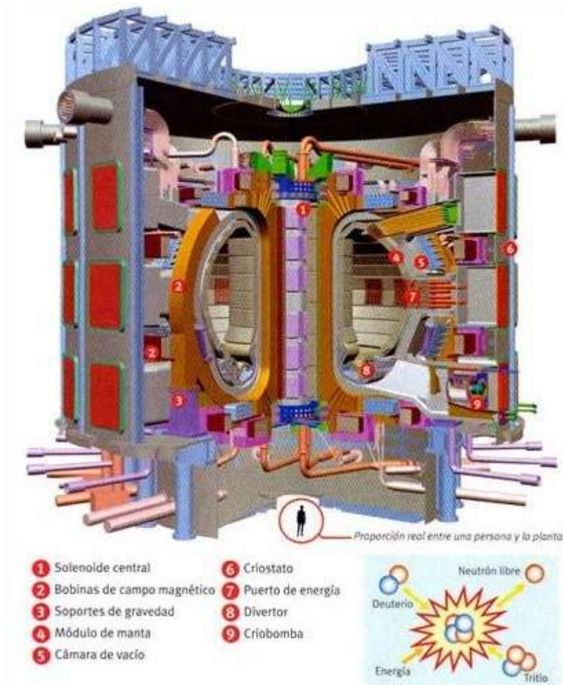
Imatge 52. Plànol del reactor amb les parts indicades. Imatge extreta de https://telosworld.com/reactores-de-fusion-nuclear/
