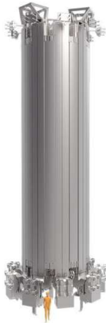
Imatge 47. Selenoide central del reactor ITER. Imatge extreta de https://www.iter.org/machine/magnets
