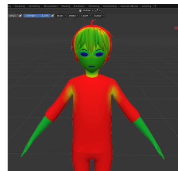
Imatge 88. Utilització de weight paint per treure outlins en parts com ulls o boca. Font pròpia
